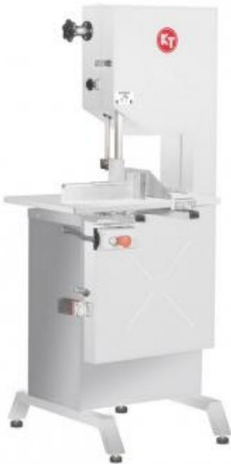
Напольная двухскоростная ленточная пила имеет либо подвижный, либо неподвижный стол. Модель оснащена удобным рычагом-толкателем и тормозным двигателем, благодаря которому режущее полотно останавливается мгновенно после выключения распиловки. Корпус изготовлен из нержавеющей стали.
