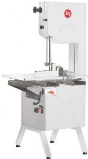
Напольная двухскоростная ленточная пила имеет либо подвижный, либо неподвижный стол. Модель оснащена удобным рычагом-толкателем и тормозным двигателем, благодаря которому режущее полотно останавливается мгновенно после выключения распиловки. Корпус изготовлен из нержавеющей стали.
