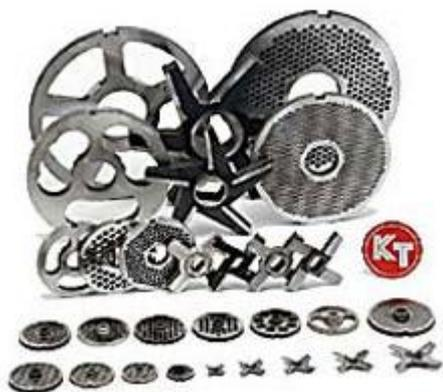
Фирма изготавливает ножи и решетки для мясорубок различных размеров типа ENTERPRISE для моделей от LM-5 до LM-42, а также типа UNGER для моделей от LM-82 до LM-300. Решетки выполнены из нержавеющей стали особой закалки. Размеры решеток варьируются от 2 мм до 30 мм. Ножи для мясорубок особой закалки и со стеллитовым покрытием. Благодаря такой комбинации материалов ножи не требуют особого ухода и имеют исключительно долгий срок эксплуатации, годами выдерживая постоянные значительные нагрузки.
